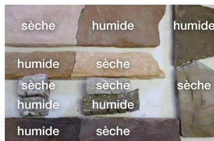
La photo suivante fournit un exemple réel dont la pierre humide installée contrastait avec le panneau échantillon de la même pierre sélectionnée. Après séchage, la pierre installée correspondait avec l'échantillon.
