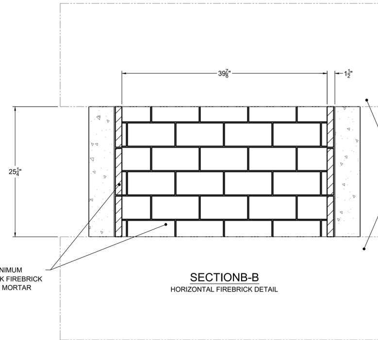
MINIMUM 1/4" THICK FIREBRICK W/ 1/4" MORTAR
