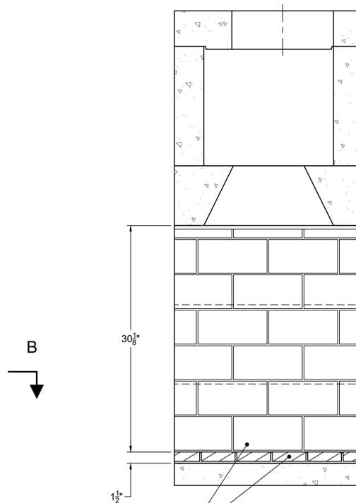
MINIMUM 1/4" THICK FIREBRICK W/ 1/4" MORTAR
